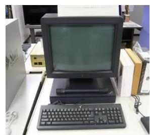
写真 10 NeXTstation Turbo
